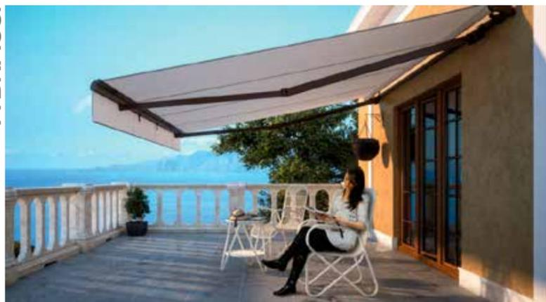
**Tirrena** - è la tenda su barra quadra 40x40, con bracci estensibili, con catena inox e calcagno rinforzato in estruso di alluminio. Il supporto braccio è rifinito con cuffie in nylon e ha la regolazione dell'inclinazione con posizioni fisse.
